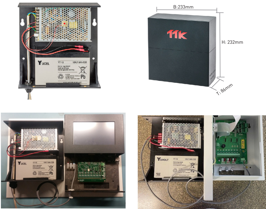
Beispiel: Verbindung eines Backupbatterie-Gerätes mit einer Steuereinheit FG-NET.
